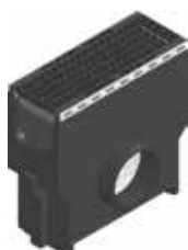
Įtekėjimo dėžė su nešvarumų indu, su GUGI tinklinėmis grotelėmis MW 15/25, kaliojo ketaus, juodos, užrakintos, klasė D 400
