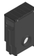
Įtekėjimo dėžė su nešvarumų indu ir išilginių juostų grotelėmis SW 9 mm, kaliojo ketaus, padengtos KTL, užrakintos, klasė C 250
