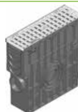
Įtekėjimo dėžė su PVC nešvarumų indu, su tinklinėmis grotelėmis MW 30/30, cinkuoto plieno, užrakintos, klasė B 125
